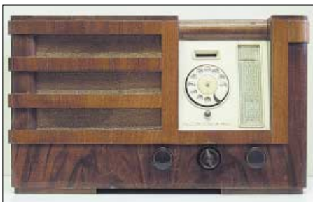
Aus der Stadt Kiel stammt dieser Empfänger der Firma Neufeldt & Kuhnke (heute Hagen): Der Nordmark Wählscheiben-Super, ein Oktodensuper für Mittel- und Langwelle aus dem Jahr 1936. Die Abstimmung wurde mittels einer Telefonwählscheibe vorgenommen und jeder Senderfrequenz war eine zweistellige Zahl zugeordnet. Bei einem Preis von 236 Mark war der Empfänger für die Mehrheit der Radiohörer unerschwinglich.
